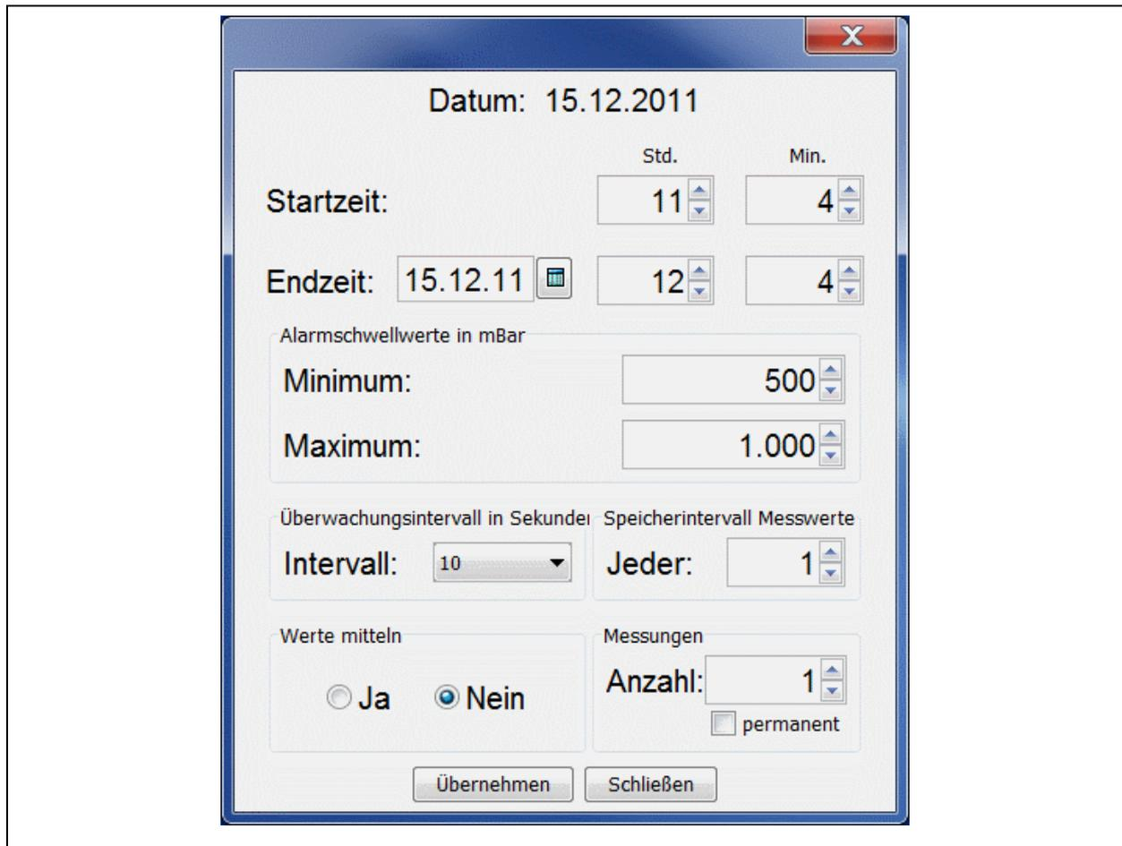
**Abbildung 3-27: Fenster Messparameter EKM**
