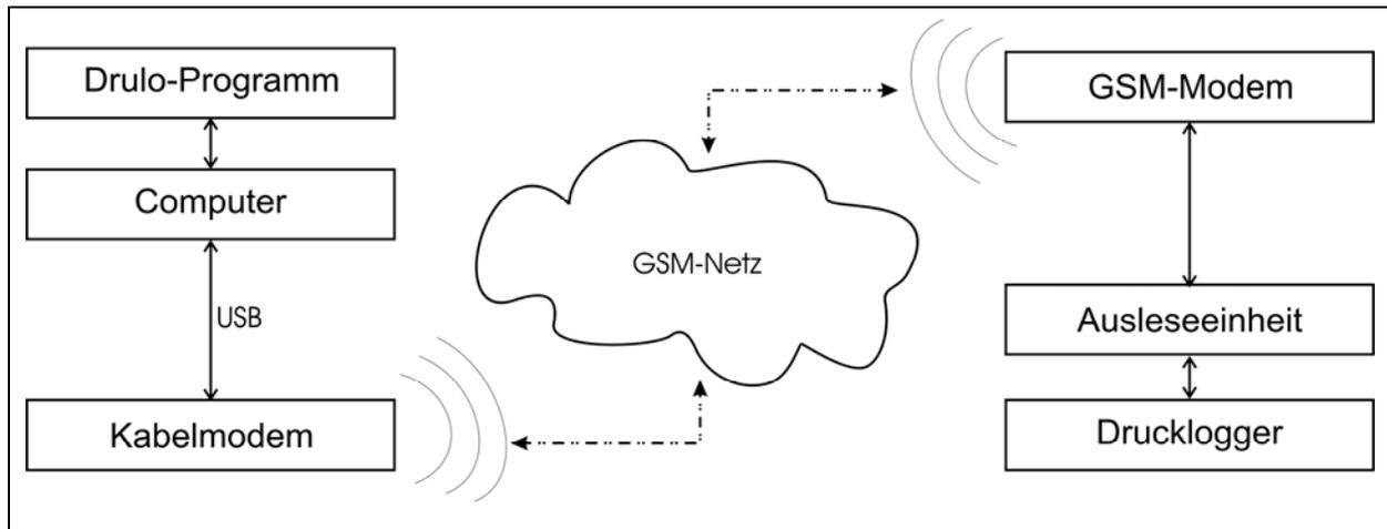
Abbildung 3-7: GSM-Verbindungsschema
